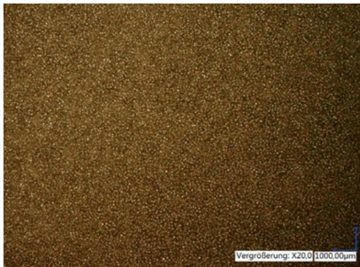
Abbildung 17b: Krater, aber durchgehend mit Lack benetzte Oberfläche (LABS-konform), Aufnahme mit Durchlicht
