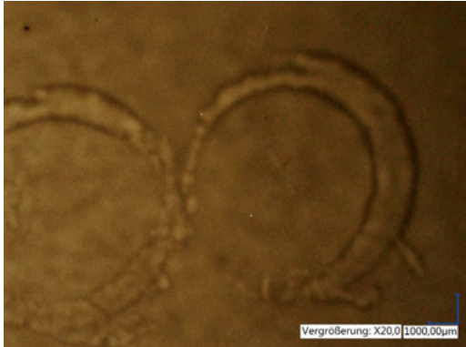
Abbildung 19b: Lösemittelränder entlang O-Ring Struktur (LABS-konform), Aufnahme mit Auflicht
