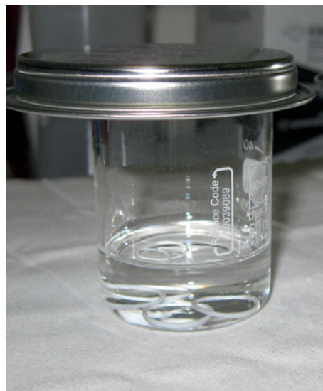
Abbildung 8: Prüfling in Behälter mit Lösemittel
