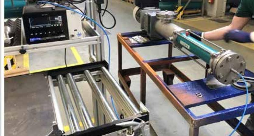
Prüfstand für Dichtigkeitsprüfung von Exzentrerschneckenpumpen
