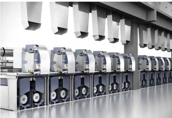
Abbildung 7: Galetten einer Spinnanlage für Textilfasern
